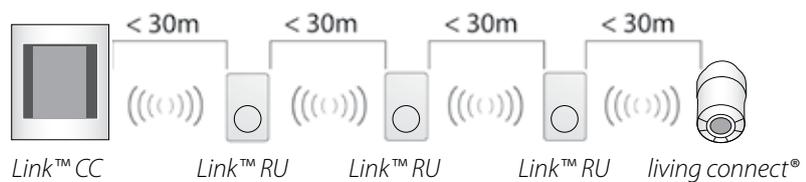
Mit Signalverstärkern lässt sich die Funkreichweite zwischen dem Zentralregler und den Installationen erweitern. Dies kann bei einer schlechten Funkverbindung notwendig sein, zum Beispiel bei weit verzweigten Installationen, großen räumlichen Abständen, dazwischen liegenden Metallgegenständen oder speziellen baulichen Gegebenheiten.
